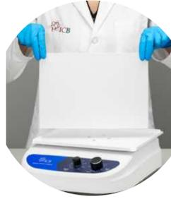
Agitación en un patrón circular y resiste una carga de hasta 1kg
