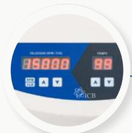
Velocidad configurable en RPM y FCR
