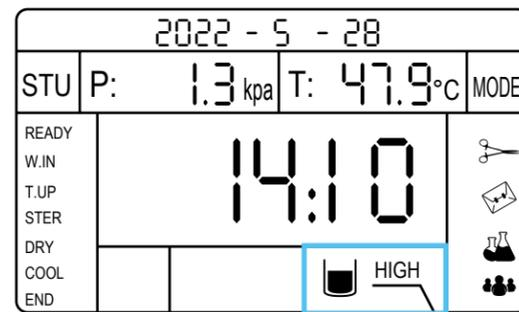
Figura 5. Indicador del nivel del agua
