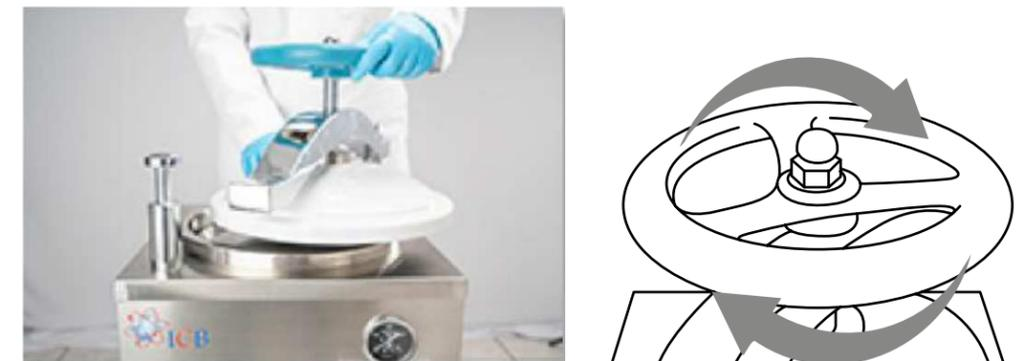
Imagen 8. Cierre de la tapa del autoclave
