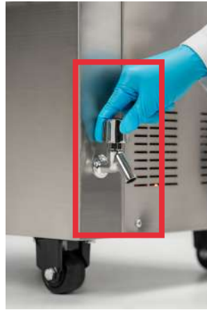
Imagen 10. Drenado de la cámara del autoclave
