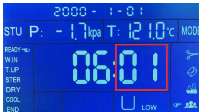
Imagen 15. Selección de drenaje de vapor
