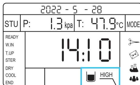
Figura 5. Indicador del nivel del agua
