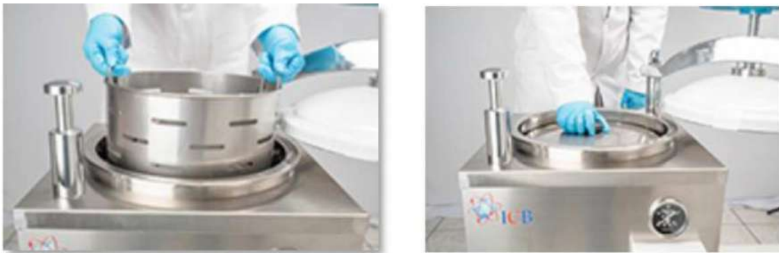
Imagen 6 y 7. Colocación de canastas
