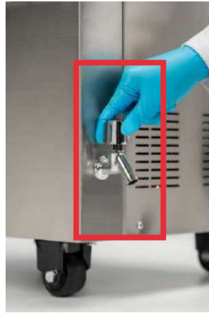
Imagen 10. Drenado de la cámara del autoclave
