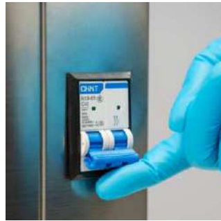
Imagen 3. Encendido del autoclave
