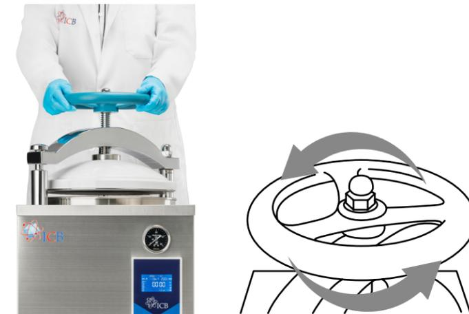
Imagen 3. Apertura de la tapa del autoclave
