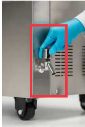
Imagen 10. Drenado de la cámara del autoclave
