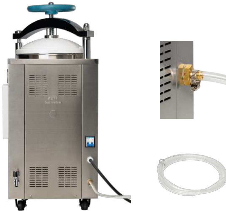
Imagen 2. Conexión y aseguramiento de la manguera de dren
