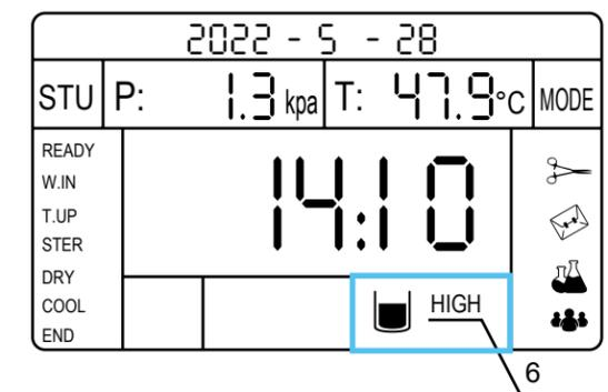
Figura 5. Indicador del nivel del agua
