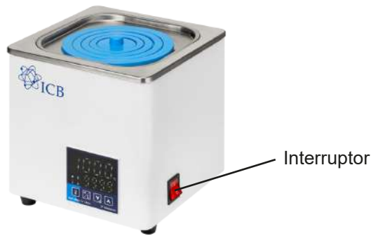
Imagen 1. Encendido del equipo
