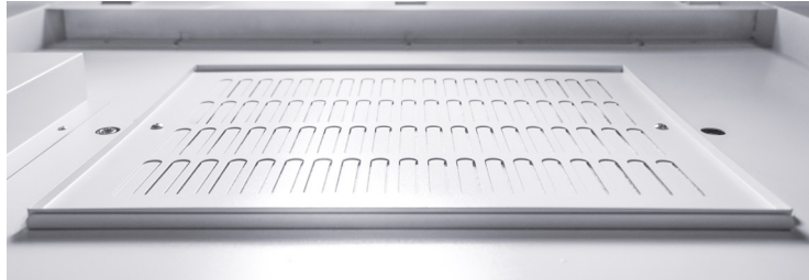
Figura 14. Acceso al Pre-filtro de la campana de flujo laminar
