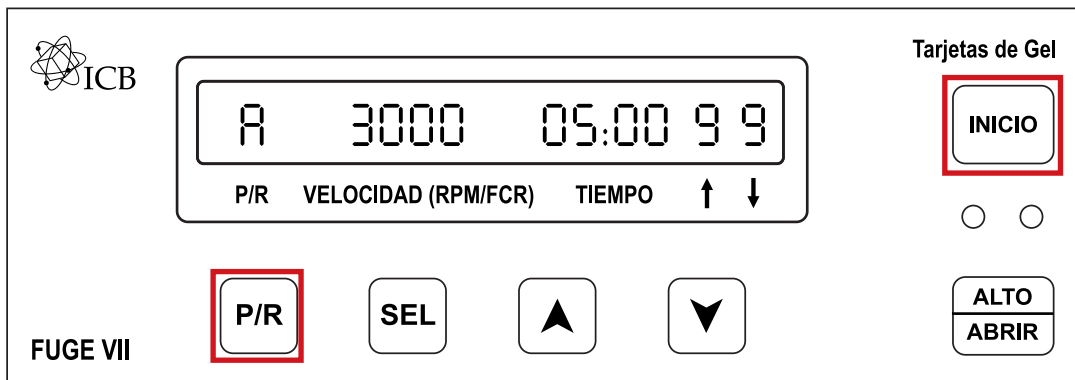
Figura 11. Indicación del botón de INICIO para recuperar programas
