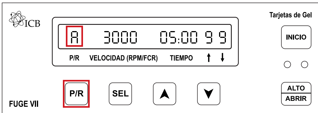
Figura 8. Indicación del botón “P/R” para la selección de memoria
