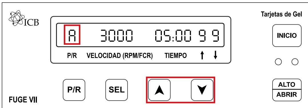
Figura 9. Indicación de las flechas para cambiar espacios de la memoria
