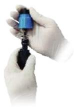
**Paso 3:** Ensamble la carcasa del eyector en la carcasa superior girándola en el sentido de las agujas del reloj.
