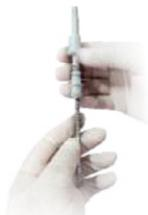
**Paso 2:** Coloque el resorte y el asiento de la junta tórica en el pistón y colóquelo dentro del cono de la punta.
