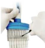
**Paso 3:** Extraiga el conjunto del cono de la punta. La junta tórica y el pistón quedaran expuestos.
