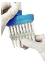
**Paso 2:** Atornille el conjunto del pistón y el cono de la punta en el soporte del pistón.
