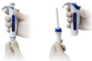
**Paso 2:** Gire el pistón en sentido contrario de las manecillas del reloj para separarlo de la carcasa del eyector de puntas.
