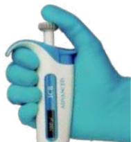
2. Suelte lentamente el émbolo mientras la punta está sumergida. El líquido será aspirado en la punta de la pipeta.
