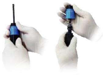
**Paso 4:** Engrase las partes limpiadas con lubricante, de preferencia con grasa de silicón.
