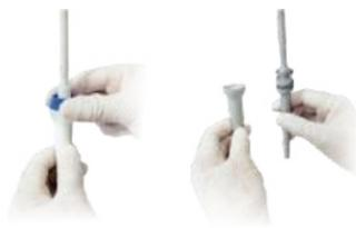
**Paso 3:** Tire del asiento de la junta tórica y gire el cono de la punta boca abajo y recupere la junta tórica.
