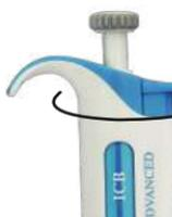
1. Establezca el volumen de entrega usando el botón en la parte superior de la micropipeta.
